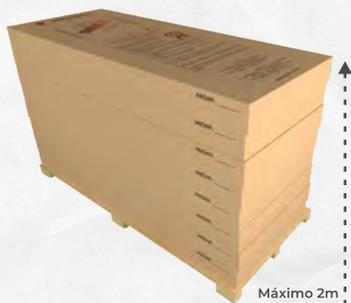
**Horizontal:** Orientamos colocar sobre estrados (não fornecidos pela Sincol) nivelados e com altura mínima de 10cm do piso. Empilhar no máximo até 2m de altura, sempre os conjuntos mais largos embaixo.
